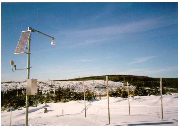
Obr. 6: Sněhoměrný polštář Hejnická na experimentálním povodí Uhlířská.
