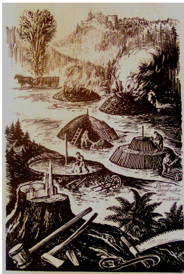
Obrázek 4.1: Výroba dřevěného uhlí v milířích [Hofmann, 1981: 13].
