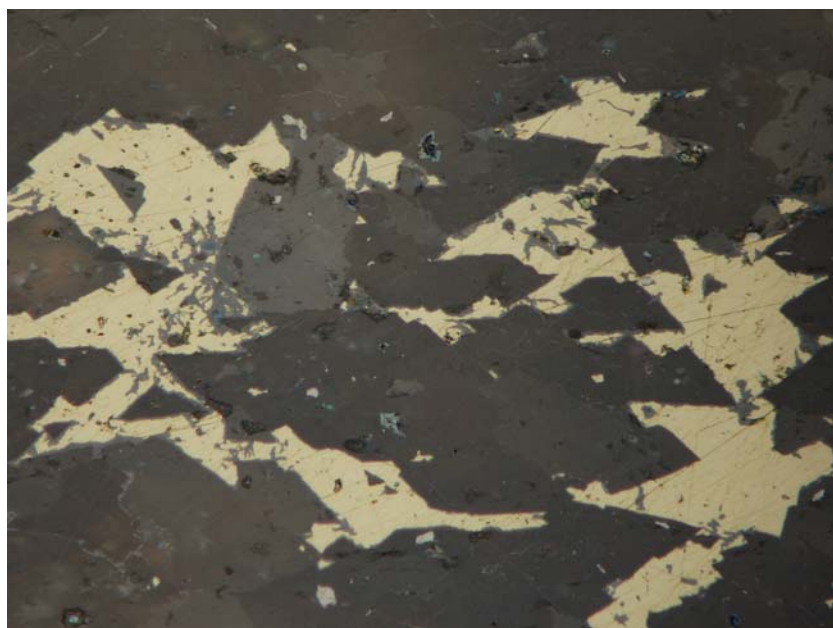
Obr. 19. Chalkopyrit vyplňující prostor mezi krystaly sideritu. Jedová hora, Národní muzeum Praha P1N 9960, sběr E. Bořický 1868. Rudní mikroskop, pozorování s jedním nikolem, šířka záběru 0,3 mm. Foto D. Velebil
