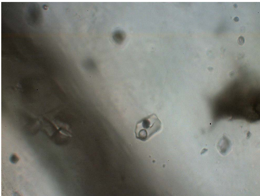
Obr. 52. LB1 - úlomek 4, šířka záběru 0,1 mm; dvoufázová H 2 O inkluze uzavírající zrno pyritu. Foto J. Zachariáš
