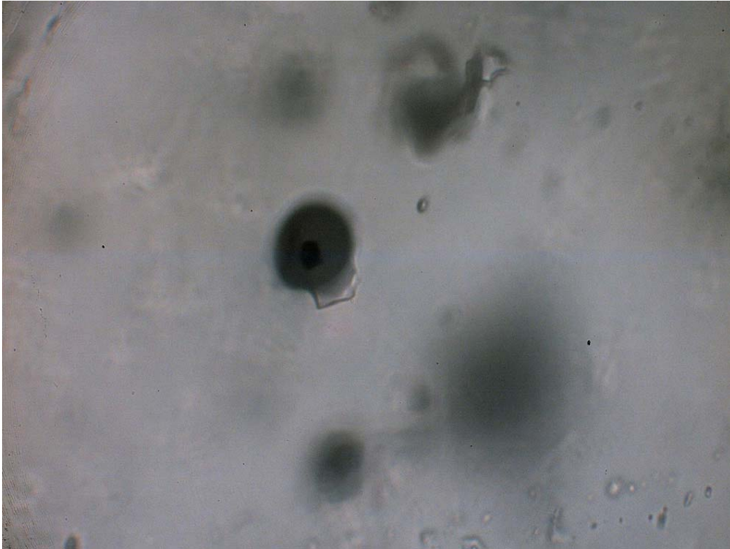
Obr. 51. LB1 - úlomek 4; kulovitý útvar se zrnem pyritu uprostřed a přiléhající fluidní inkluzí, šířka záběru 0,1 mm. Foto J. Zachariáš
