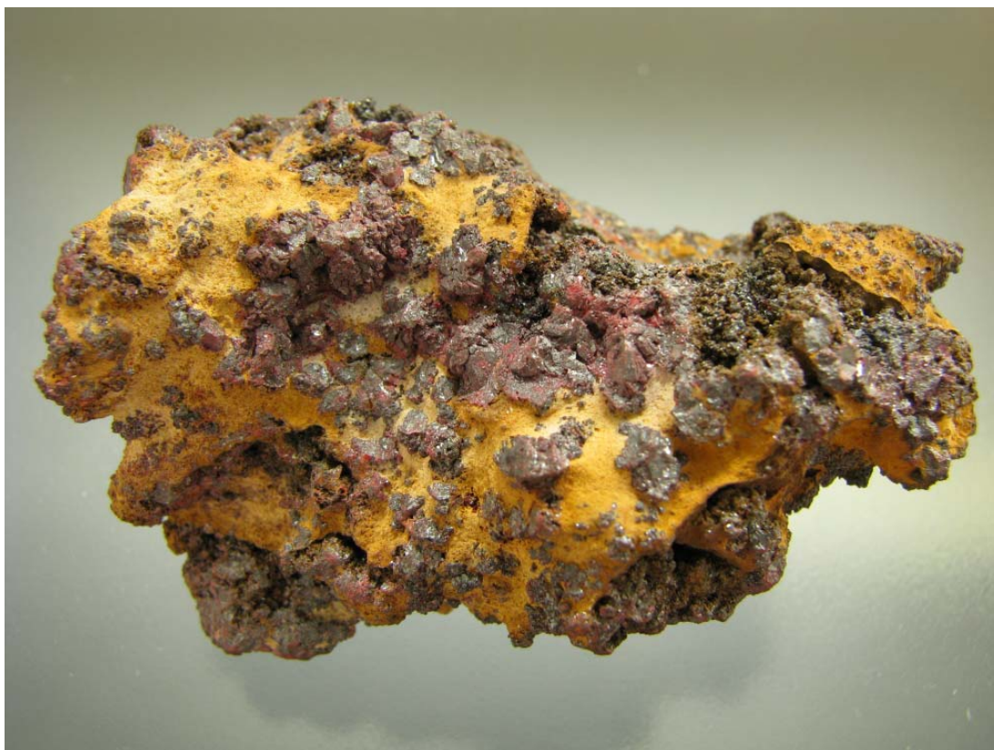
Obr. 14. Cinabarit, Jedová hora (halda šachty Barbora 1989) - zrnité agregáty a hypautomorfní až 3mm krystaly s limonitem, velikost 5,5×4 cm. Foto D. Velebil
