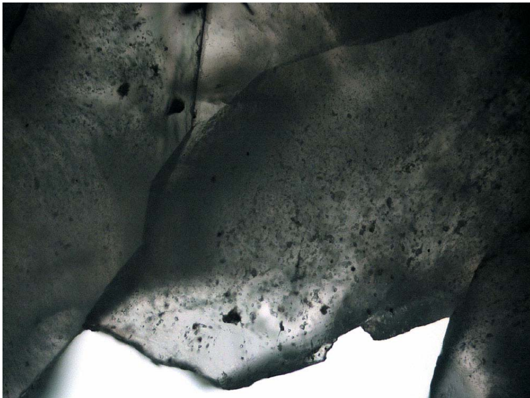
Obr. 65. Vzorek JH1 - úlomek A1, šířka záběru 1 mm, starší šedý křemen, mladší čirý při okraji zrna křemene. Foto J. Zachariáš
