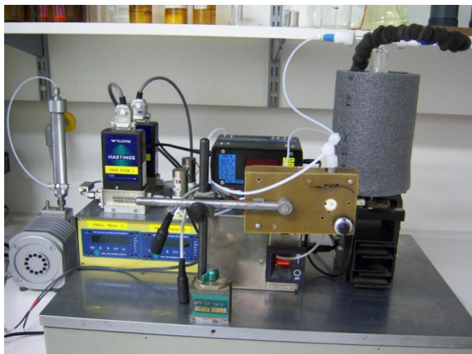
Obr.6: Aparatura pro produkci definované koncentrace analytu v plynné fázi
