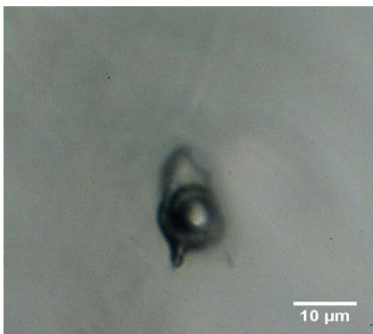
Obr. 24. Zřetelně pozorovatelný třífázový obsah u měřené inkluze typu H 2 O-CO 2 , F ~0,8.
