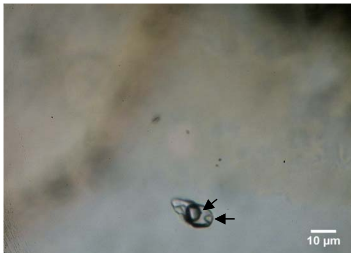
Obr. 16. Samostatná \text{H}_2\text{O-CO}_2 inkluze se zachycenou drobnou rudní a nerudní fází (vyznačeno šípkami).
