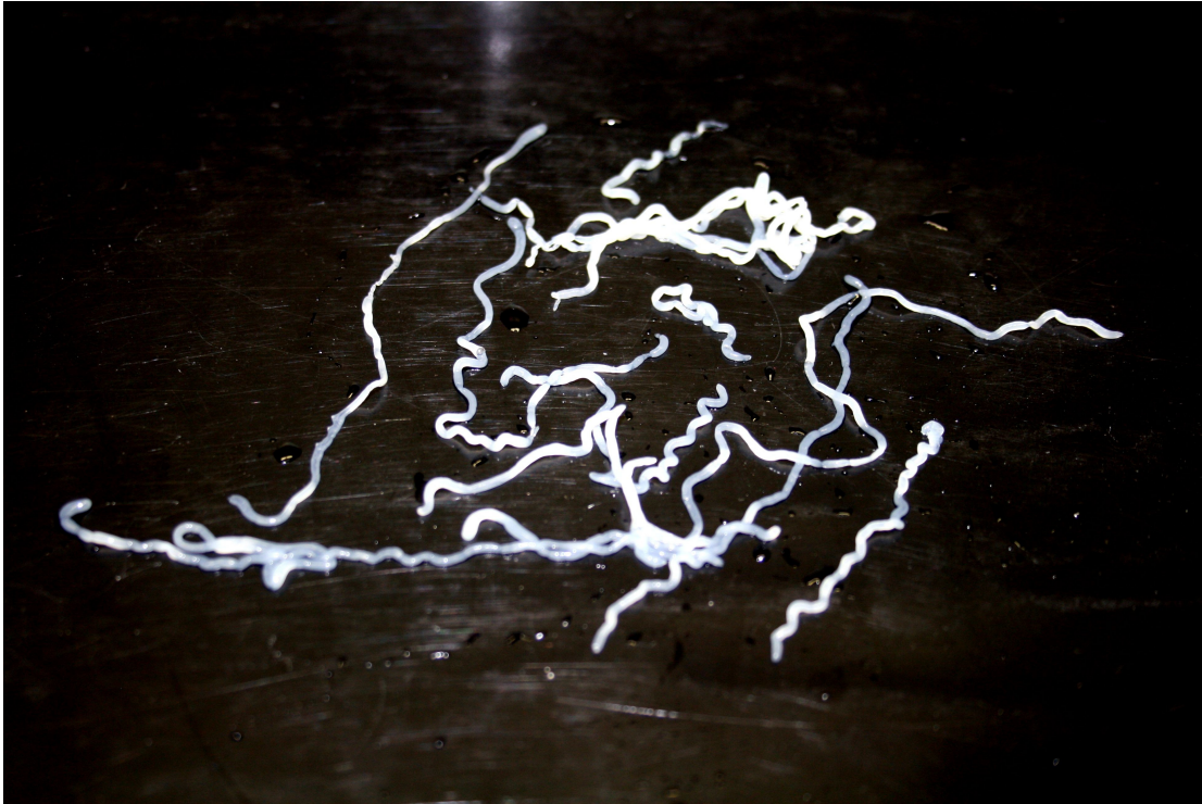
Obrázek č. 60 Vlákna Rayonu – vlákna polosyntetického polymeru Rayonu připravena amoniokuprátovou metodou.
