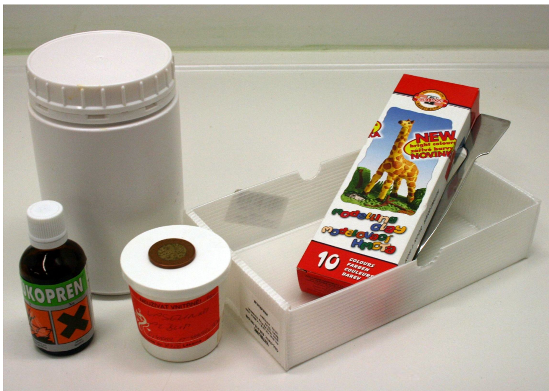
Obrázek č. 50 Příprava experimentu – „historická mince“, Lukopren N 1522, Lukopren katalyzátor, vazelína, plastový rámeček s podložkou, plastelína a špachtle.
