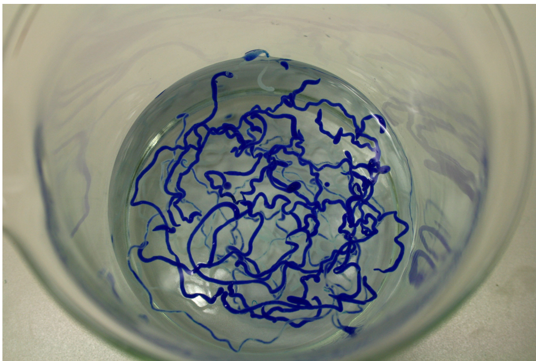
Obrázek č. 58 Rayon – vlákna Rayonu těsně po vymáčknutí roztoku celulosy ze stříkačky.
