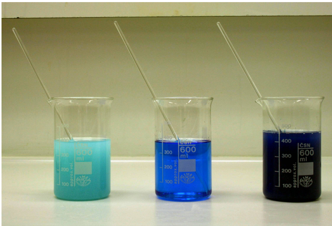
Obrázek č. 25 Výsledek experimentu – v levé kádince je světle modré činidlo, prostřední kádinka obsahuje roztok modrého komplexu glycinu s mědnatými ionty, v pravé kádince je roztok modrého komplexu vaječných proteinů s mědnatými ionty.
