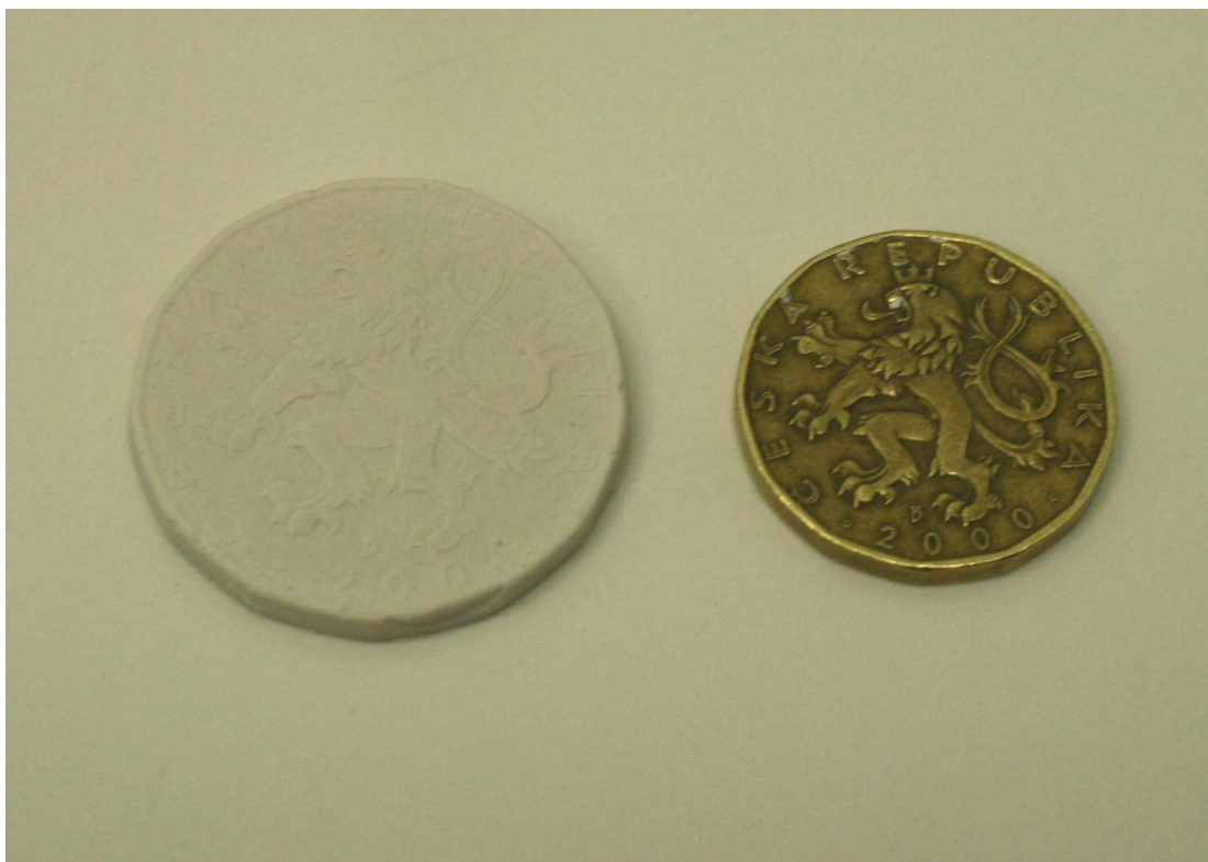
Obrázek č. 53 Zvětšování objektu – nechá-li se forma např. přes noc v toluenu nebo jiném rozpouštědle, forma se zvětší. Zvětšení záleží na druhu rozpouštědla a kaučuku. Zvětšení formy z Lukoprenu N 1522 za použití toluenu bylo cca 40%.
