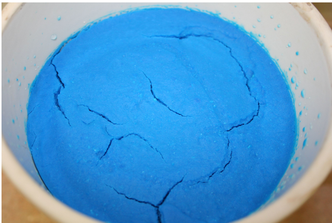
Obrázek č. 57 Hydroxid mědný – mléčně modrá sraženina hydroxidu mědnatého vznikla reakcí síranu mědnatého a hydroxidu sodného v roztoku chlazeném ledem.
