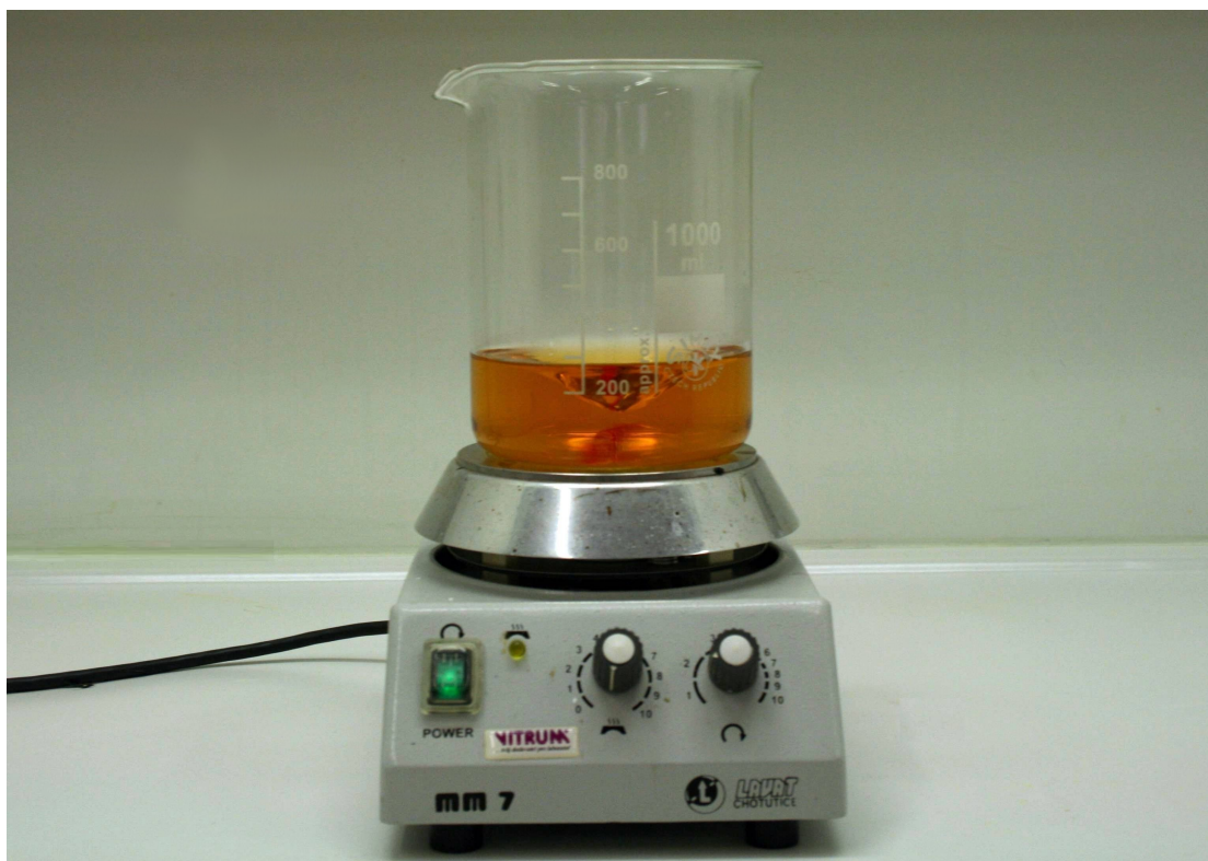
Obrázek č. 28 Reakční směs před přidáním roztoku C – roztok barvy jantaru vzniklý slitím roztoku A a B na magnetické míchačce.
