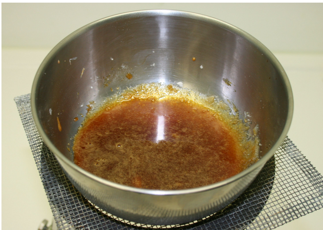
Obrázek č. 36 Příprava směsi – sacharosa zkaramelizovala a spojila se s dusičnanem draselným v pastu.
