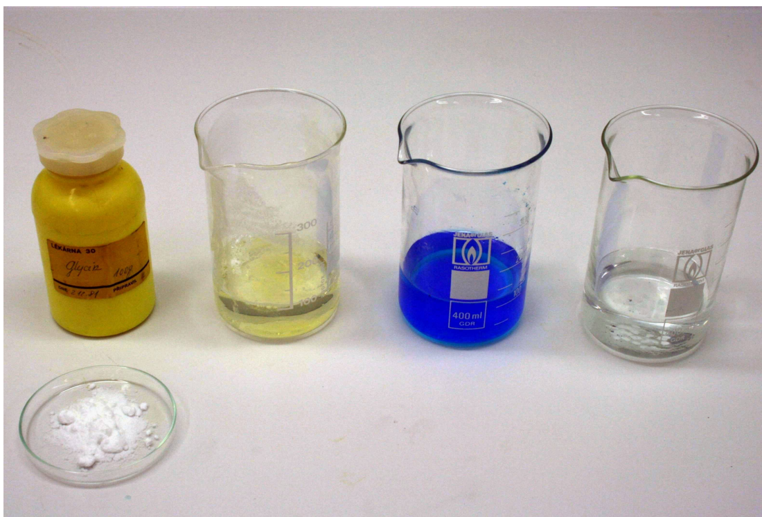
Obrázek č. 24 Příprava experimentu – zleva aminokyselina glycin, vodný roztok vaječného bílku, vodný roztok pentahydrátu síranu mědnatého, vodný roztok hydroxidů sodného.
