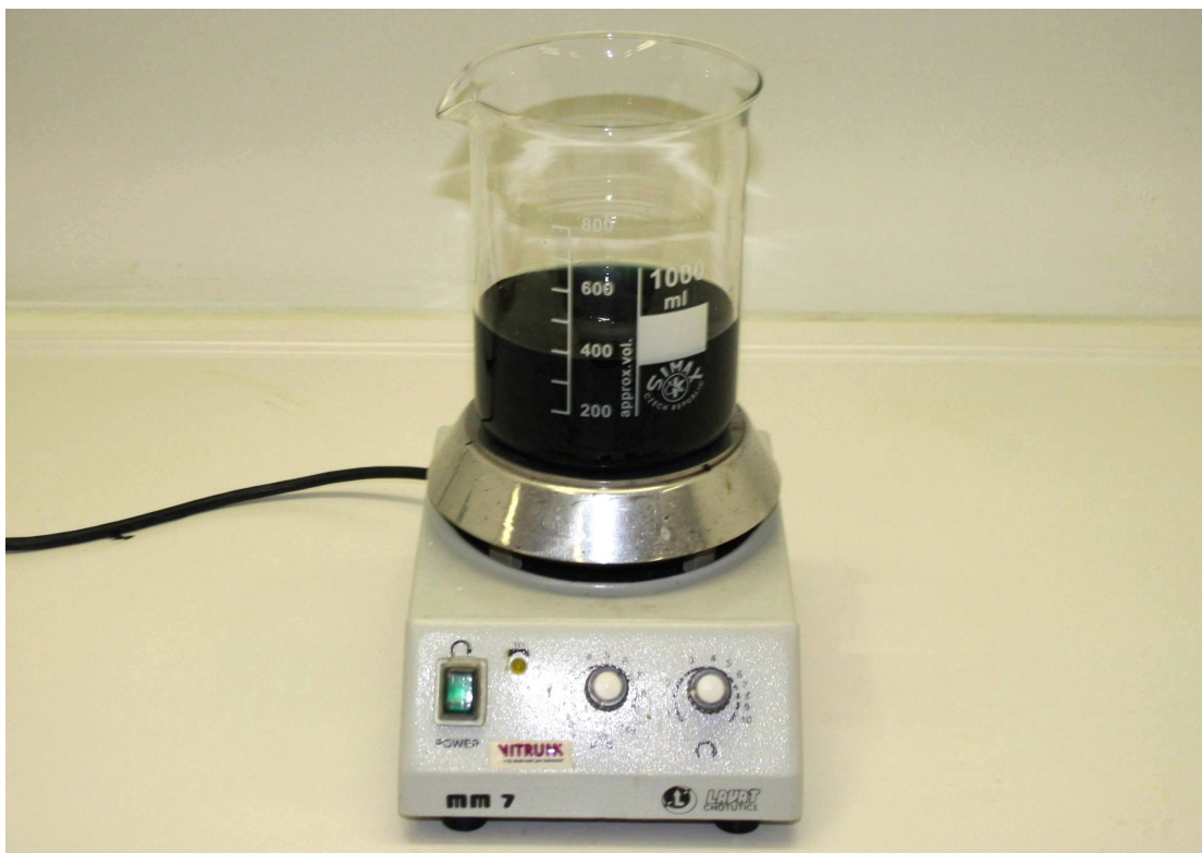
Obrázek č. 30 Modročerné zabarvení roztoku – zabarvení roztoku vzniká v důsledku začlenění I_3^- do struktury škrobu. V tomto okamžiku převládá bezradikálový mechanismus.
