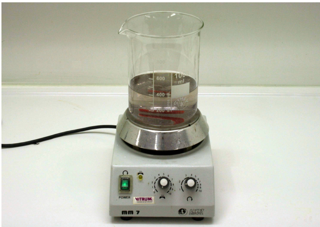
Obrázek č. 29 Odbarvení roztoku – fáze odbarvení roztoku. V této fázi je nedostatek jodidových iontů, tedy převládá radikálový mechanismus.
