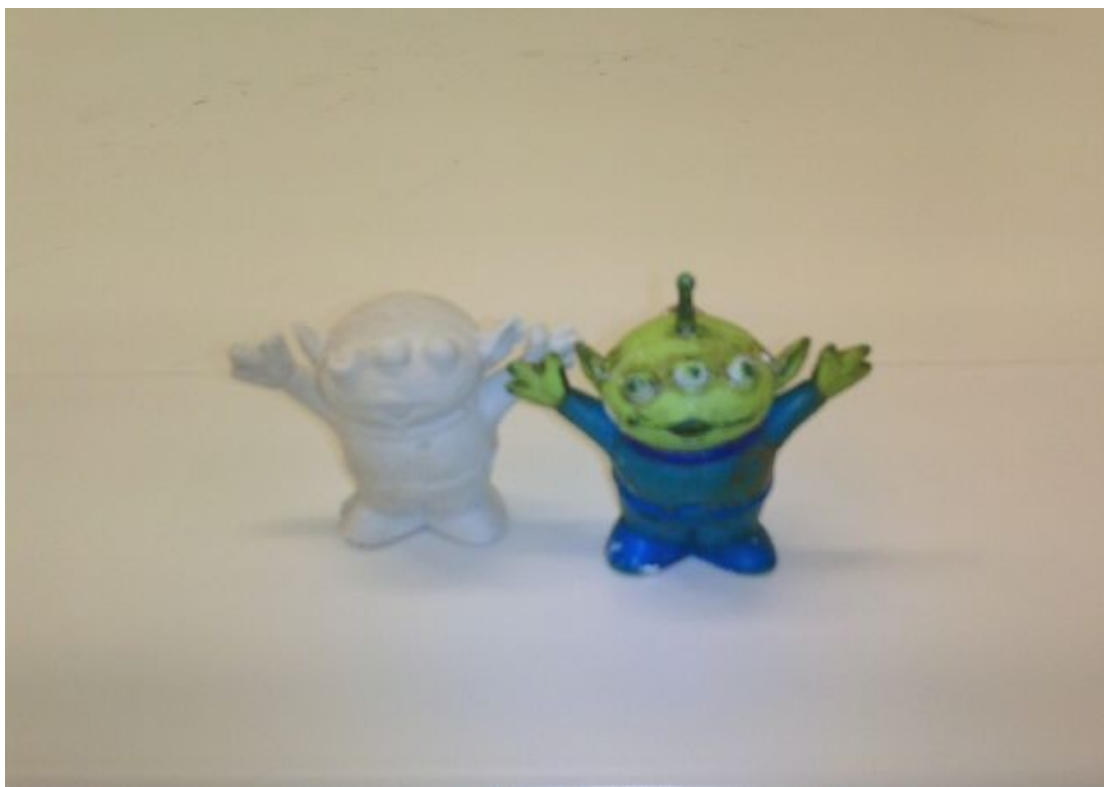
Obrázek č. 55 Mimosťan a jeho trojrozměrný odlitek – anténka se bohužel během vyformování repliky ulomila.
