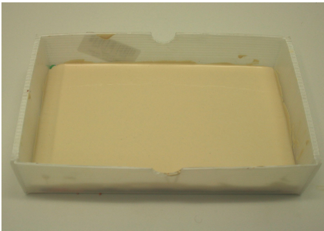
Obrázek č. 51 Probíhající vulkanizace – po převrstvení objektu silikonovou pastou nastává vulkanizace, čili zesíťování jednotlivých složek za vzniku pružné silikonové formy.
