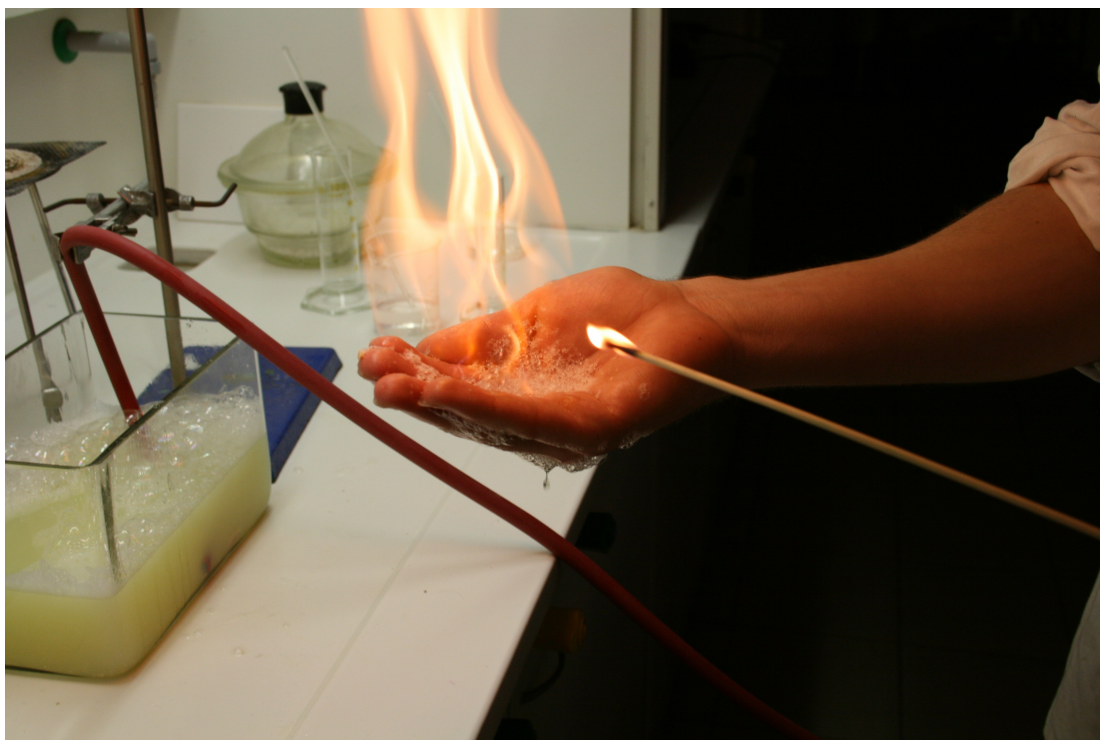
Obrázek č. 41 Hořící ruka – ruka je chráněna a chlazena mýdlovým roztokem. Navíc je plyn lehčí než vzduch, takže stoupá a minimalizuje tak účinky ohně. Plamen hoří kolem tří vteřin, záleží na množství sebraných bublin.
