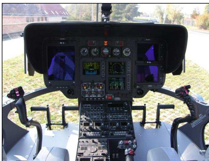
Obr.č. 15- pohled na přístrojový panel vrtulníku v EC 135 T2
