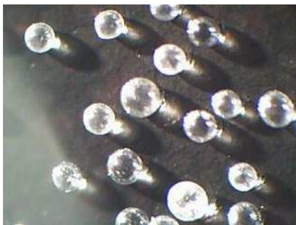
Obr 4.1 – neporóvité skleněné kuličky o průměru 325-430 \mu\text{m} se zvětšením 100
