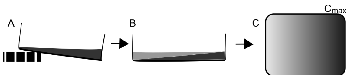
Obr. 11 Příprava gradientové misky. První vrstva (A) s aditivem o koncentraci C_{max} nalitá do nakloněné misky. Druhá vrstva (B) bez aditiv nalitá ve vodorovné poloze. Schéma hotové misky (C) koncentrace aditiva roste zleva doprava.
