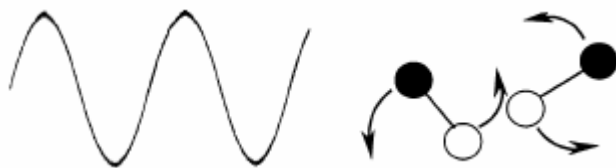
Obrázek č. 3: Dipolární molekuly snažící se přizpůsobit oscilujícímu elektrickému poli
