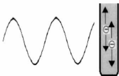
Obrázek č. 4: Nabité částice v roztoku následující působící elektrické pole
