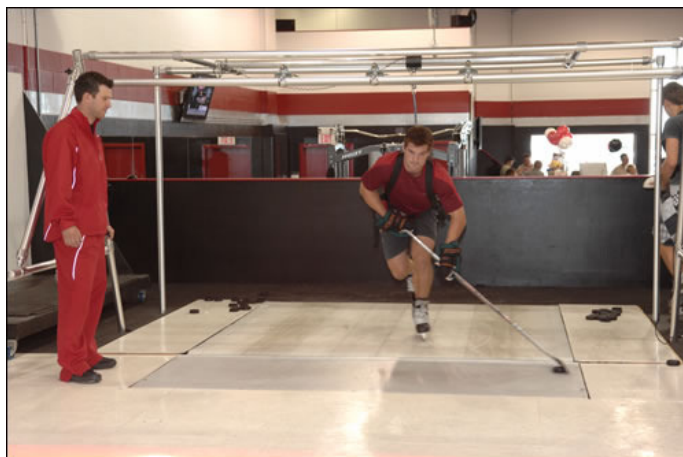
Obrázek 1 – bruslařský trenažér - Pomocí trenažéru se získávají data o technice bruslařského skluzu a odrazu, postavení jednotlivých částí těla a funkčnost tzv. kinetického řetězce. Všechno se realizuje pomocí bruslařského trenažéru a dvou videokamer, které hráče snímají. Tak je získán dokonalý obraz o technice bruslení. ( www.klhchomutov.cz )
