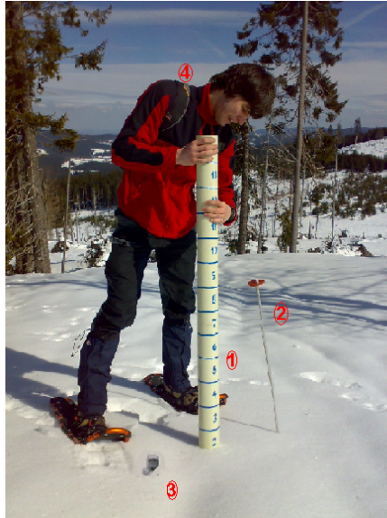
Obr. 17: Sněhoměrná souprava SM 150-50
