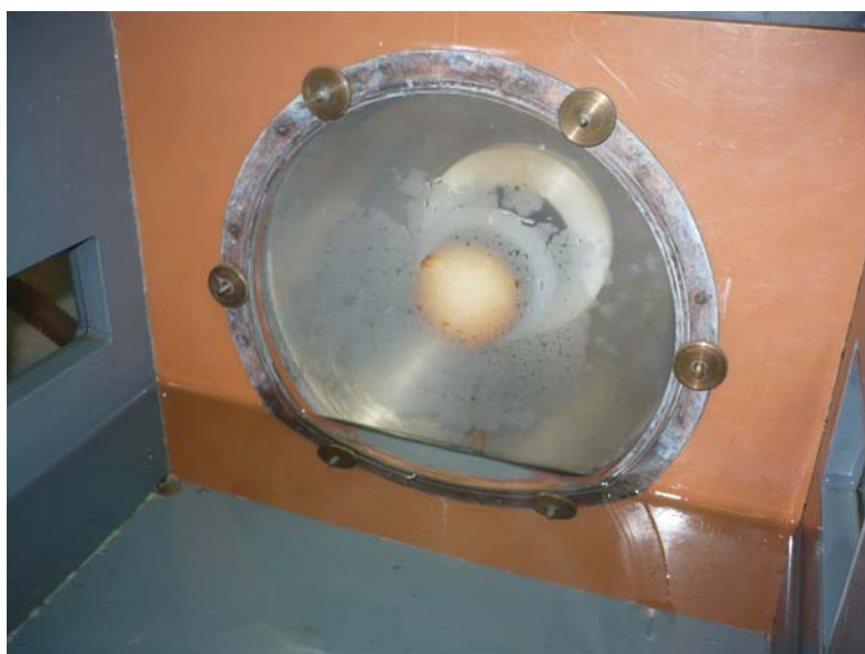
Obr. 15. Pohled na akusticky transparentní membránu, která odděluje oba prostory pokusného zařízení.
