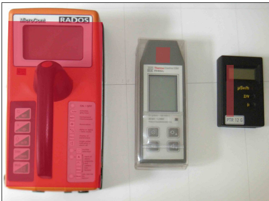
Obr.3.2. Velikosti detektorů v jednotlivých přístrojích (označeno červeně)
