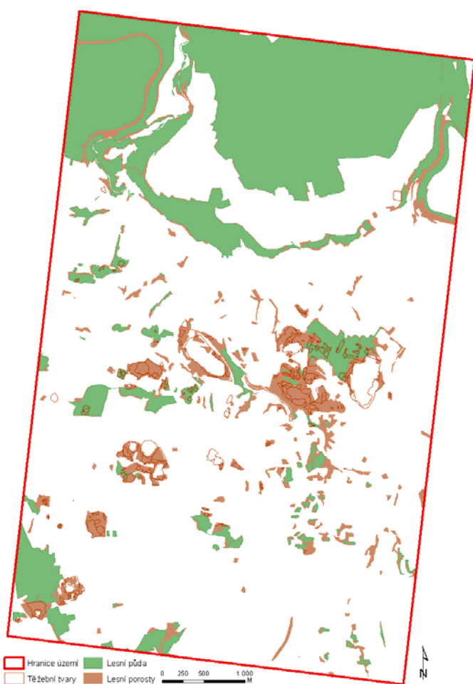
Obr. 16. Mapa těžebních tvarů, rozlohy lesních porostů z databáze ZABAGED a lesní půdy podle katastrální mapy. Lesní porosty mimo lesní půdy se nacházejí především na výsypkách a v okolí lomů.
