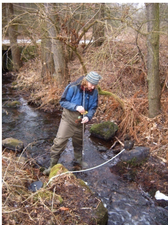
Obr. 101: Měření průtoků v profilu Spálený Mlýn (foto: J. Čurda)
