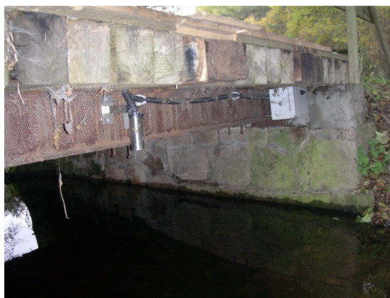
Obr. 103: Původní hladinoměr v profilu Spálený Mlýn (foto: autor)
