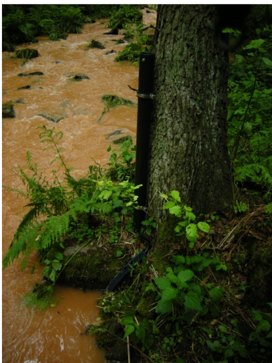
Obr. 100: Hladinoměr na Mladotickém potoce pod jezerem (foto: autor)
