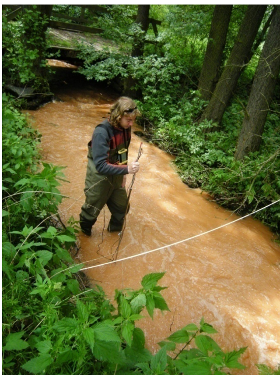
Obr. 104: Měření průtoků v profilu Spálený Mlýn po povodni – 28.5.2009 (foto: M.Stehlík)
