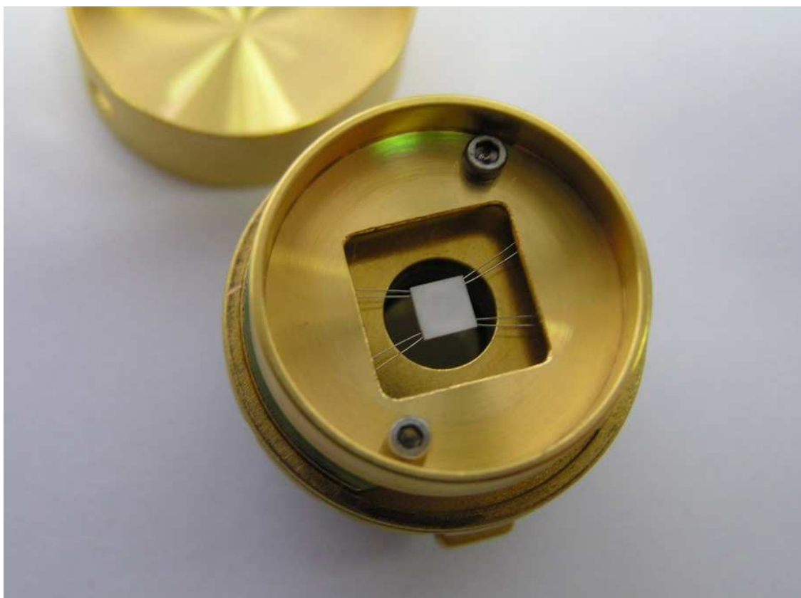
Obrázek 3.4.1. Držák na vzorek pro měření měrného tepla. Vzorek umísťujeme na šedou podložku uprostřed, která má rozměry 3×3 mm
