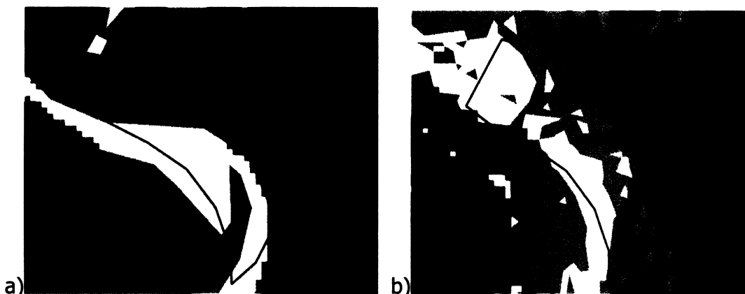
Obr. 4. (a) zastavěné plochy (šedá linie) nad přesnějším sklonem svahu odvozeným z DMR vygenerovaného metodou splajně, (b) zastavěné plochy (šedá linie) nad nepřesným sklonem svahu odvozeným z DMR vygenerovaného metodou IDW
