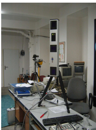
Obrázek 2. Snímací jednotka CX1 (autorské foto)
