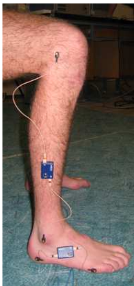
Obrázek 4. Umístění senzorů a zesilovacích boxů bérce a noze (autorské foto)
