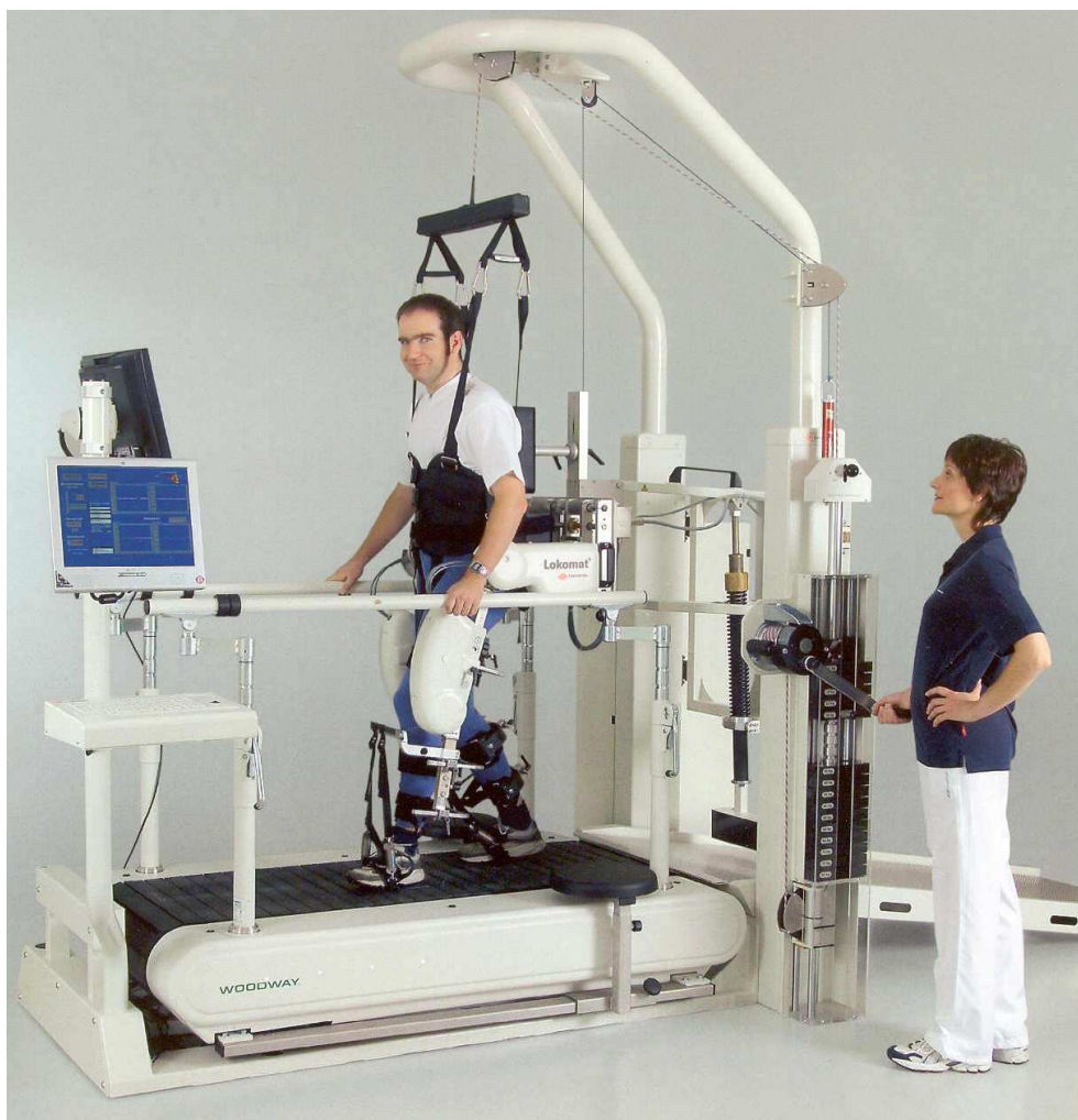
Obrázek č. 1 - pacient při terapii v přístroji Lokomat (robotická ortézy + treadmill – pohyblivý chodník + Lokobasis – systém na podporu hmotnosti).
