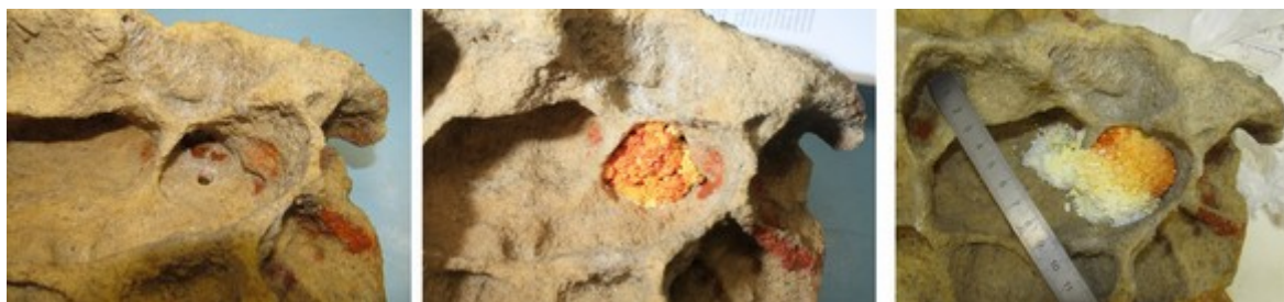
Obr. 4.53: Detail místa, kde se nejvíce objevoval fluorescein a krystaly soli. Vlevo stav před počátkem injektace síranu sodného, uprostřed stav v polovině května a vpravo na začátku července.
