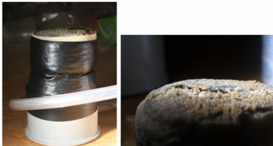
Obr. 4.94: Vytvořená aparatura pro transport soli jádrem pískovce. Vpravo detail naříznuté krusty, pod kterou se vysrážela sůl. Foto: J. Bruthans
