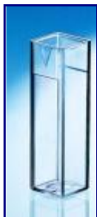
Obrázek 10-1: Kyveta pro měření velikosti nanočástic
