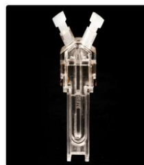
Obrázek 10-2: Kyveta pro měření zeta potenciálu nanočástic
