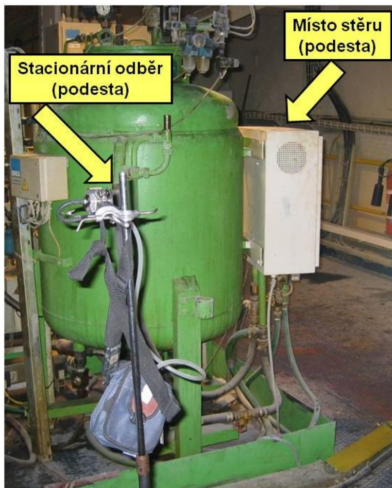
Obrázek č. 23. Stěr z povrchu zařízení u stacionárního odběru TDI (podesta)
