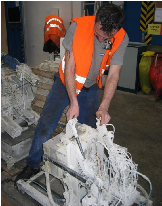
Obrázek č. 19. Pracovník údržby při pravidelné údržbě licí hlavy
