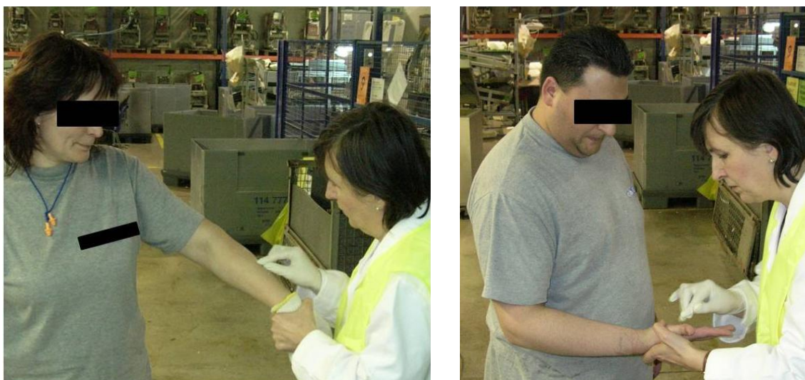
Obrázek č. 26 a 27. Technika stěru z předloktí (vlevo) a z dlaně
