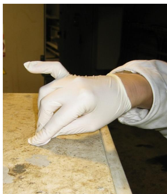
Obrázek č. 24 a 25. Technika stěru z povrchu zařízení, navlhčení (vlevo) a stěr
