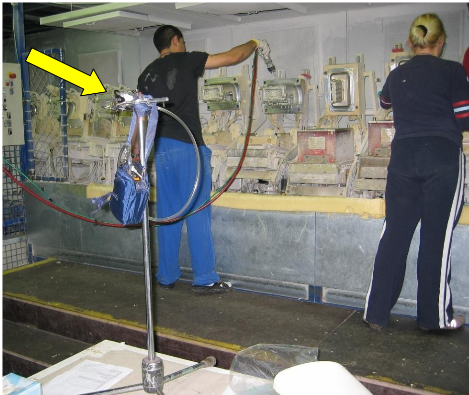
Obrázek č. 21. Stacionární odběr TDI v pracovním ovzduší
