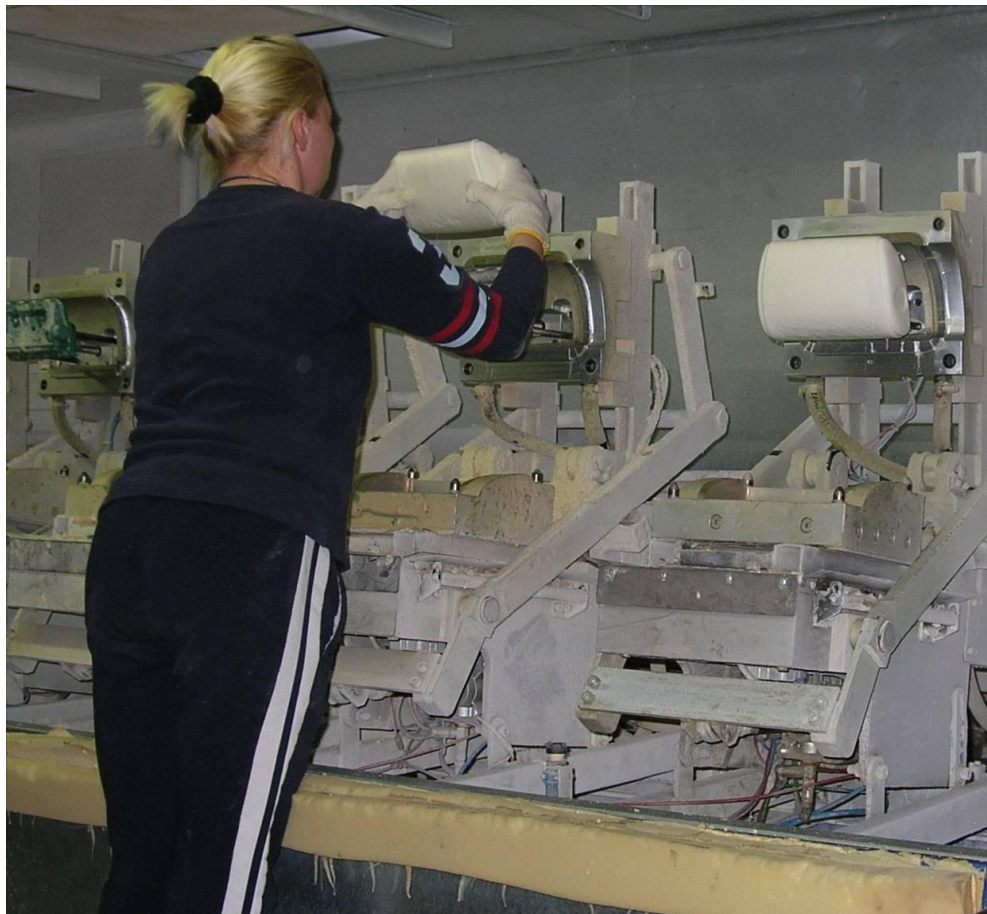
Obrázek č. 15. Výrobní linka - čištění forem a separace (horní i čelní odsávání)
