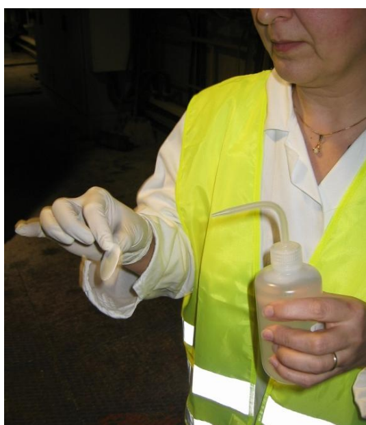
Obrázek č. 24 a 25. Technika stěru z povrchu zařízení, navlhčení (vlevo) a stěr
