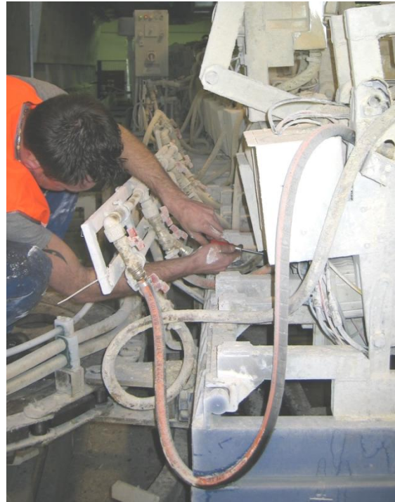
Obrázek č. 19. Pracovník údržby při pravidelné údržbě licí hlavy
