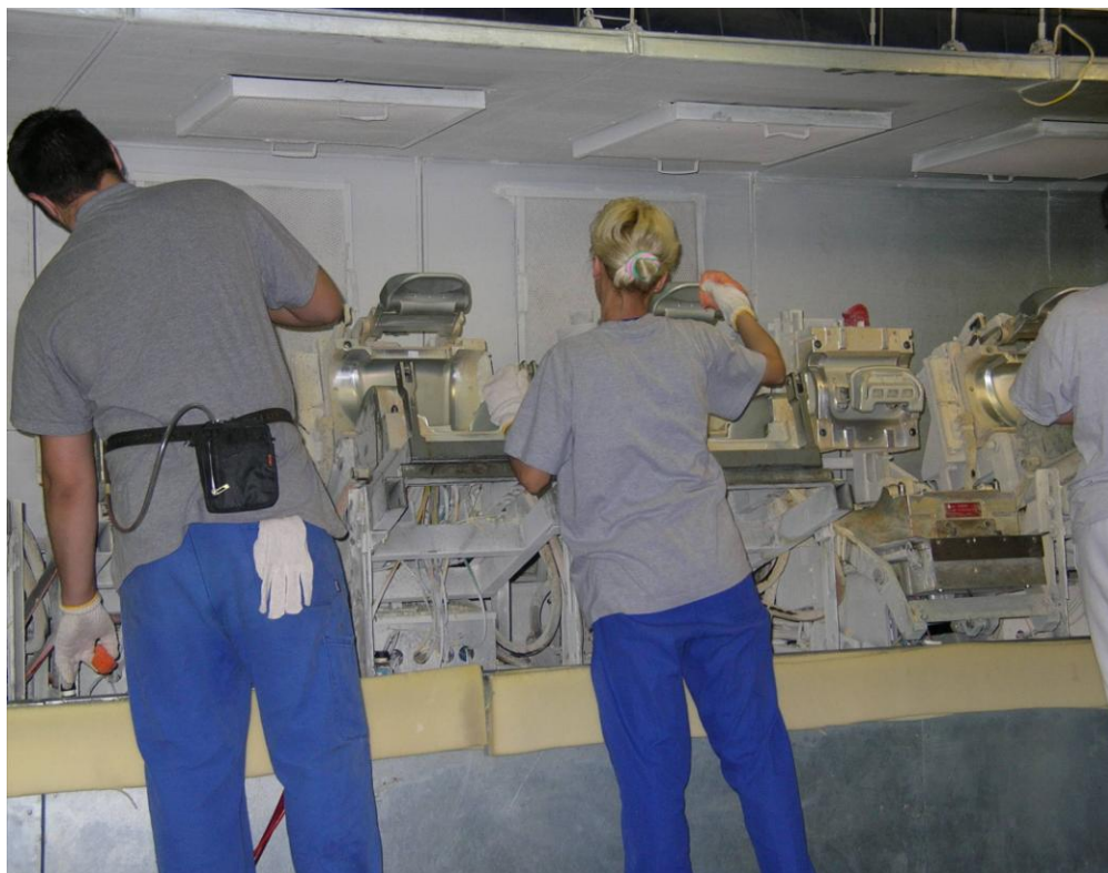
Obrázek č. 15. Výrobní linka - čištění forem a separace (horní i čelní odsávání)
