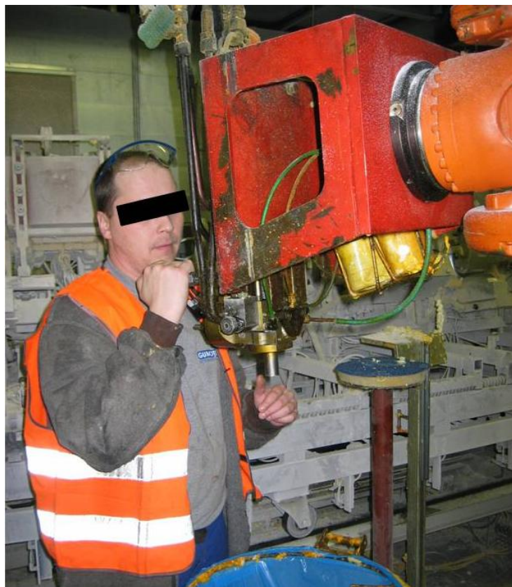
Obrázek č. 19. Pracovník údržby při pravidelné údržbě licí hlavy
