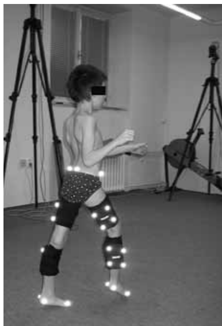
Obr. 1 Pacient s aplikovanými reflexními markery během vyšetření kinematické analýzy chůze v biomechanické laboratoři CASRI, Praha. V pozadí je vidět infračervené kamery ProReflex240 (Qualisys, Švédsko)
