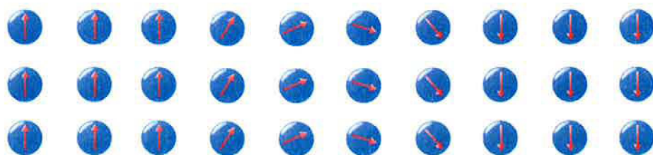
Obrázek 2.2: Schématické znázornění změny směru magnetizace v Blochově stěně.
