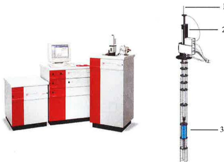
Obrázek 3.2: Zařízení MPMS: 1) táhlo se vzorkem; 2) komora na vyrovnání tlaků 3) supravodivý solenoid.
