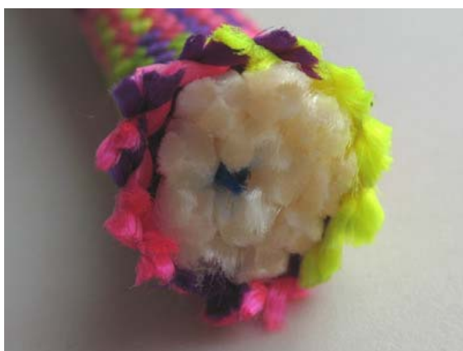
Obrázek 17: Kontrolní nit uvnitř lana
