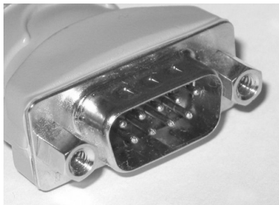
Obrázok 1 (prevzatý z [5]): RS-232 konektor
