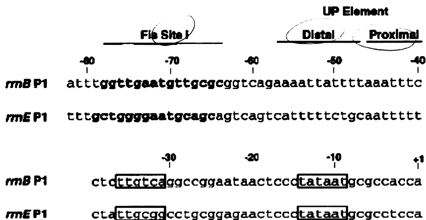
obr. 16: Sekvence rRNA promotorů z E. coli , v rámečku -10 a -35 hexamer. Oblast distálního, proximálního UP elementu a Fis oblasti je označena nad sekvencemi. Převzato z [29].
