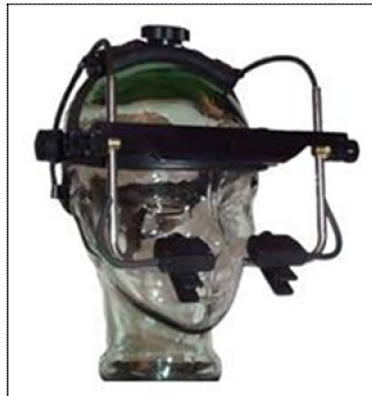
Obr. 4: Čelenka systému EyeLink II na sledovanie očných pohybov (prevzaté z [37]). Obsahuje tri kamery na sledovanie pohybu očí. Jej veľkosť je možné prispôbovať.
