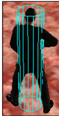
Obr. 14: Kolízny cylinder avatara. Tvar cylindra rozhoduje, či avatar vstúpil do nejakej oblasti. Jeho výšku a priemer a je možné nastaviť pomocou konfiguračného skriptu.
