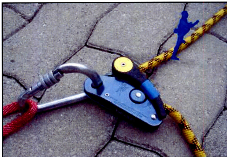
Obrázek 6 Založení lana do pomůcky Grigri Petzl (Lienerth, 2009)
