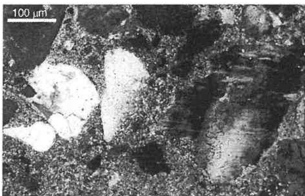
Obr. 11. Mikrofotografie (zkřížené nikoly)-fissuring (malta z pomalého cementu) (Varas a kol., 2005)
