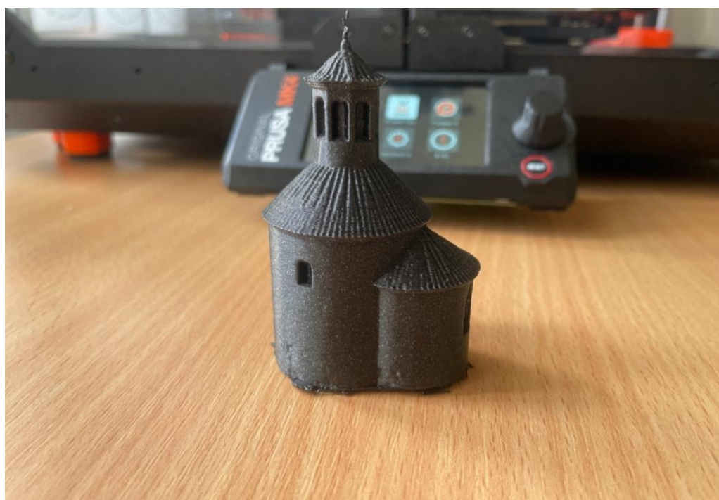
18. Vytiskřený 3D model rotundy sv. Longina na 3D tiskárně Original Prusa MK4
