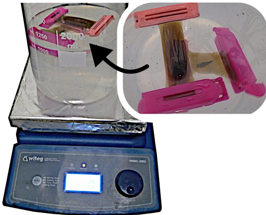
Obrázek 24: Čištění vzorku magnetickým mícháním v roztoku
