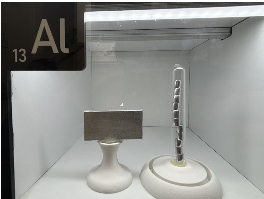
Obrázek 10: Hliník na PřF UK, vlevo pasivovaný, vpravo nepasivovaný, foto autor
