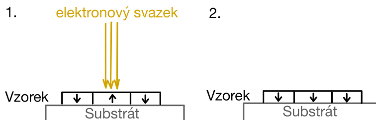
Obrázek 3.5: Schéma zachycující princip přepínání polarizace pomocí expozice elektronovým svazkem, v 1.kroku je vzorek s feroelektrickými doménami v jednom místě ozářen elektronovým svazkem, v 2. kroku je vidět změna orientace polarizace v ozářené doméně
