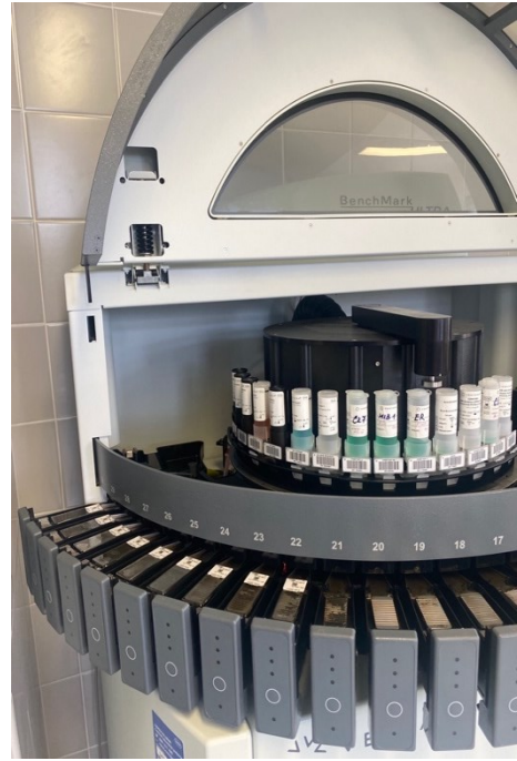
Obr.15 Barvicí automat BENCHMARK VENTANA ULTRA (vlastní zdroj)
