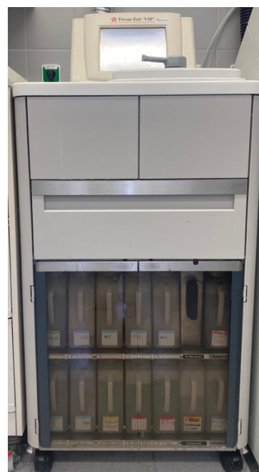
Obr.2 Tkáňový procesor VIP 6 (vlastní zdroj)
