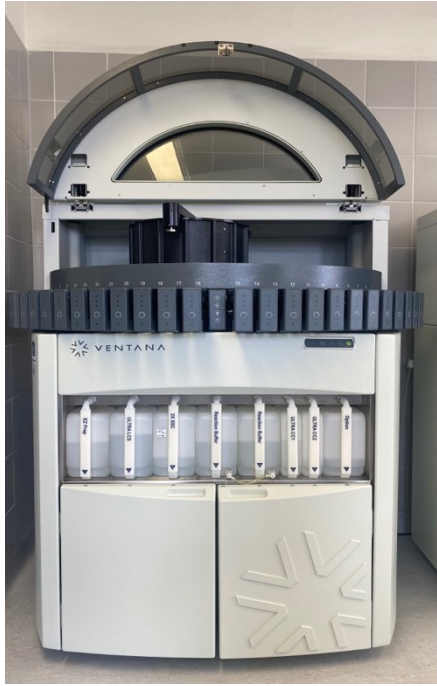
Obr.14 Barvicí automat BENCHMARK VENTANA ULTRA (vlastní zdroj)
