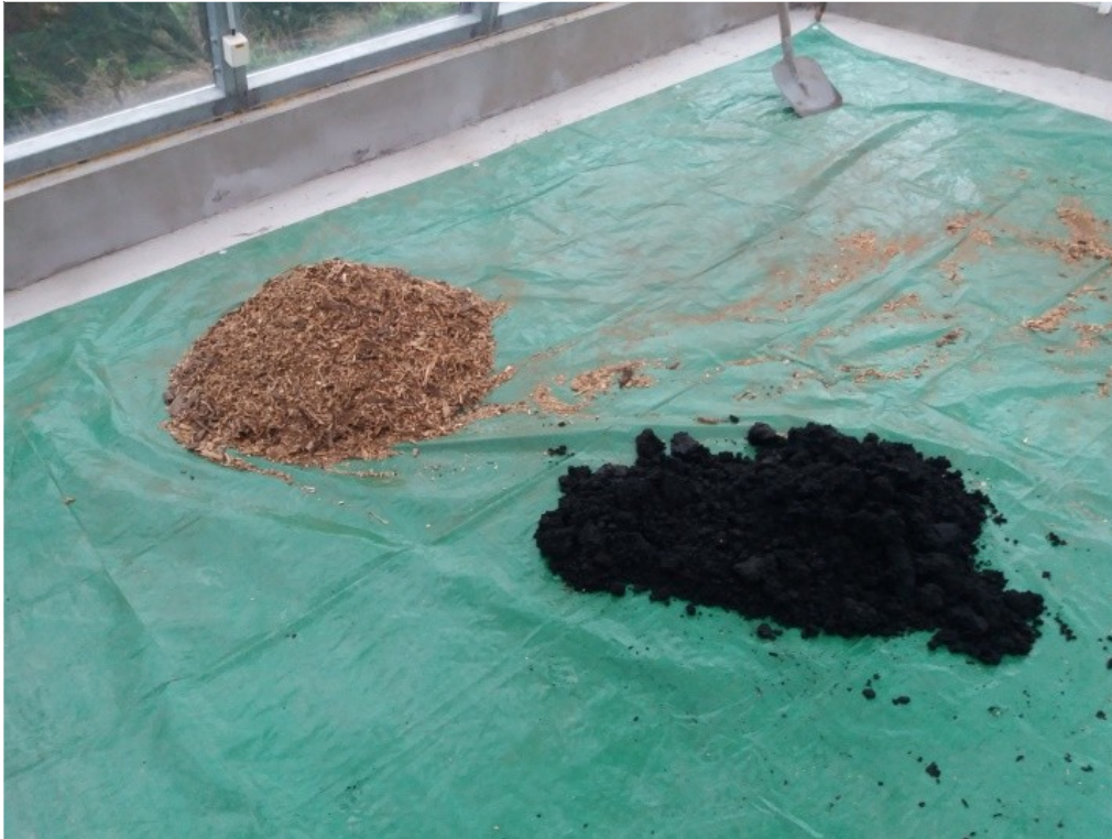
Obr. č. IX dokumentace míchání kalu a štěrky před vložením do čtvrtprovozního reaktoru biosušení
