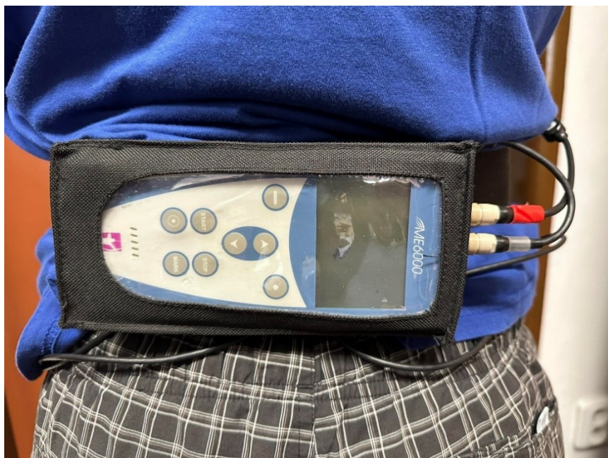
Obrázek 10: Umístění Biomonitoru ME6000 na probandovi
