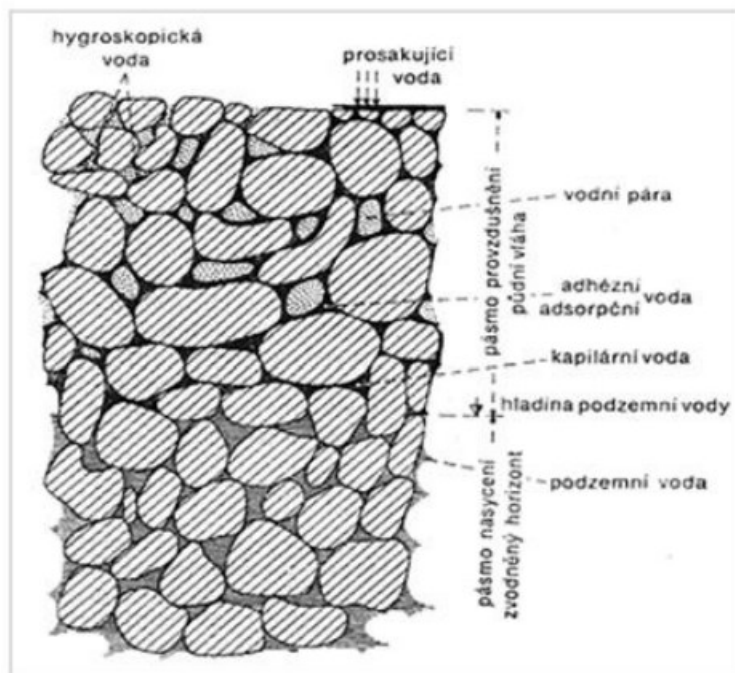
Obrázek 8: Rozložení druhů podpovrchových vod v horninách. Zdroj: Ruda 2013 (online) dle Netopil 1972
