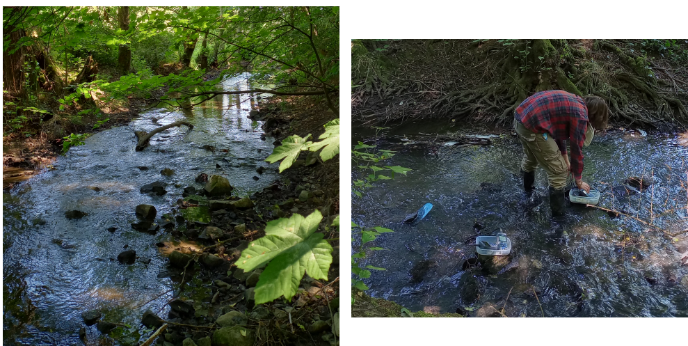
Obrázek 4.3: Charakter toku Loděnice na lokalitě ID2 (vlevo) a umisťování konduktometrů GS1 a GS3 do proudu (vpravo). Foto T. Ondovčín.
