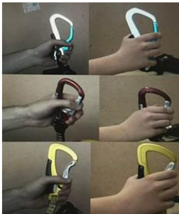
Obrázek 14 Rozdíly stlačování pojistek u dospělých (levý sloupec) a dětí (pravý sloupec). (Nahoře ERGOTEC, uprostřed ATTAC, dole One-Touch) (Lehner et al., 2012)
