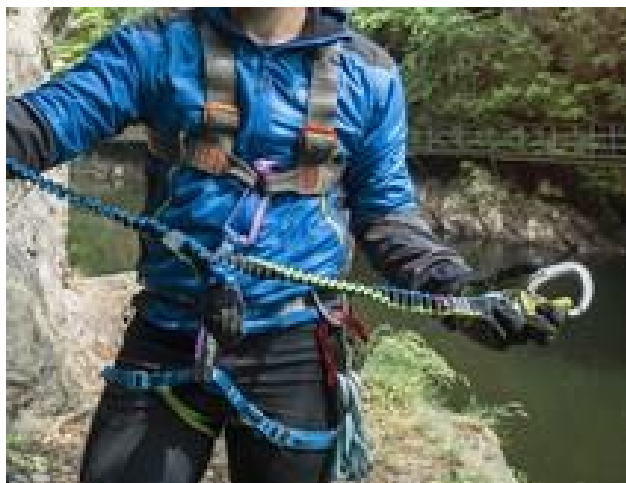
Obrázek 9 Správně navázaný kombinovaný úvazek společně s jistícím setem (Hanibal.cz, 2023a)
