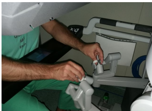
Obr. 53 Robotický systém da Vinci Xi® - přenos pohybů rukou operujícího chirurga (foto autor)
