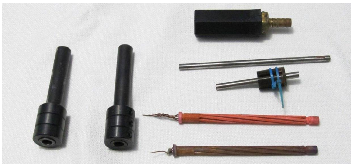
Obrázek 14 – Dvě hotové hlavěň vyrobené metodou ECM a použité přípravky
