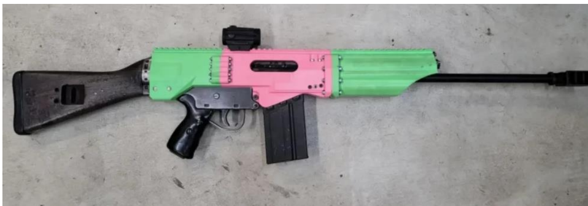
Obrázek 15 – AMIGO GRANDE – 3D tištěné tělo zbraně
