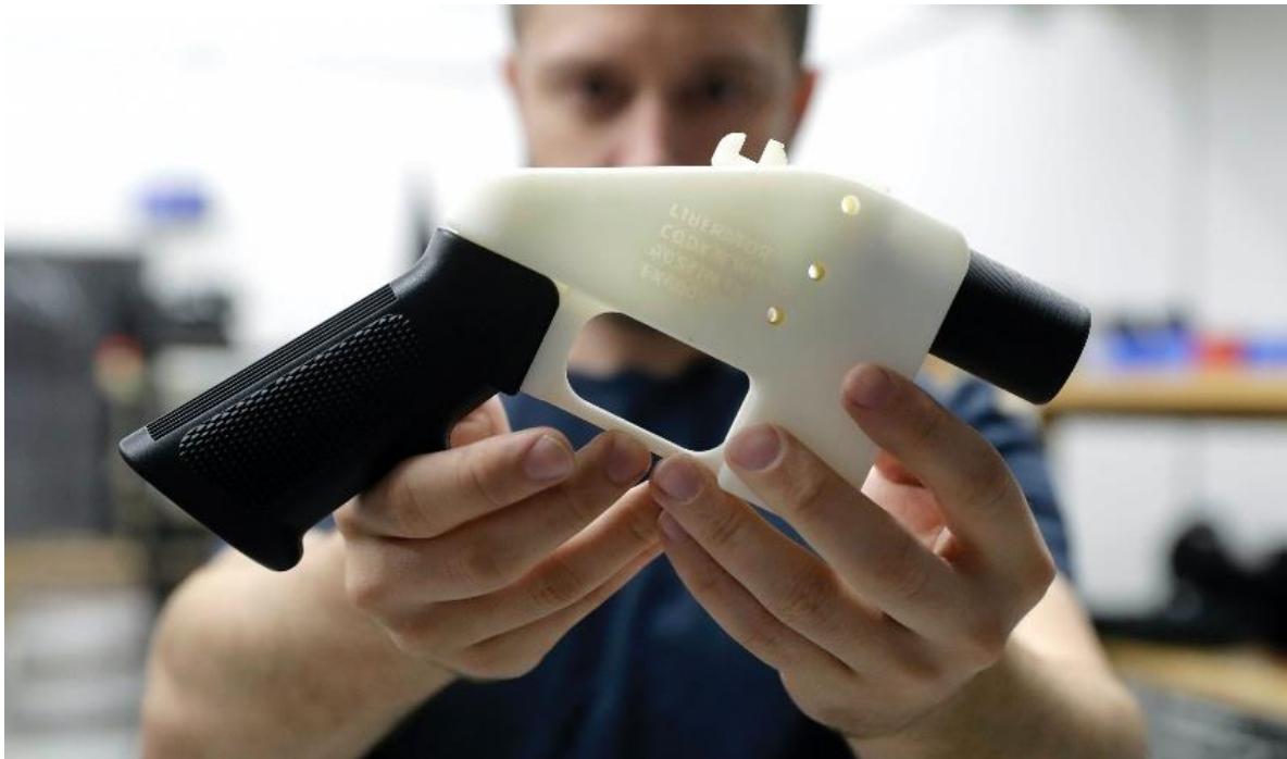
Obrázek 10 – 3D tištěná pistole Liberator
