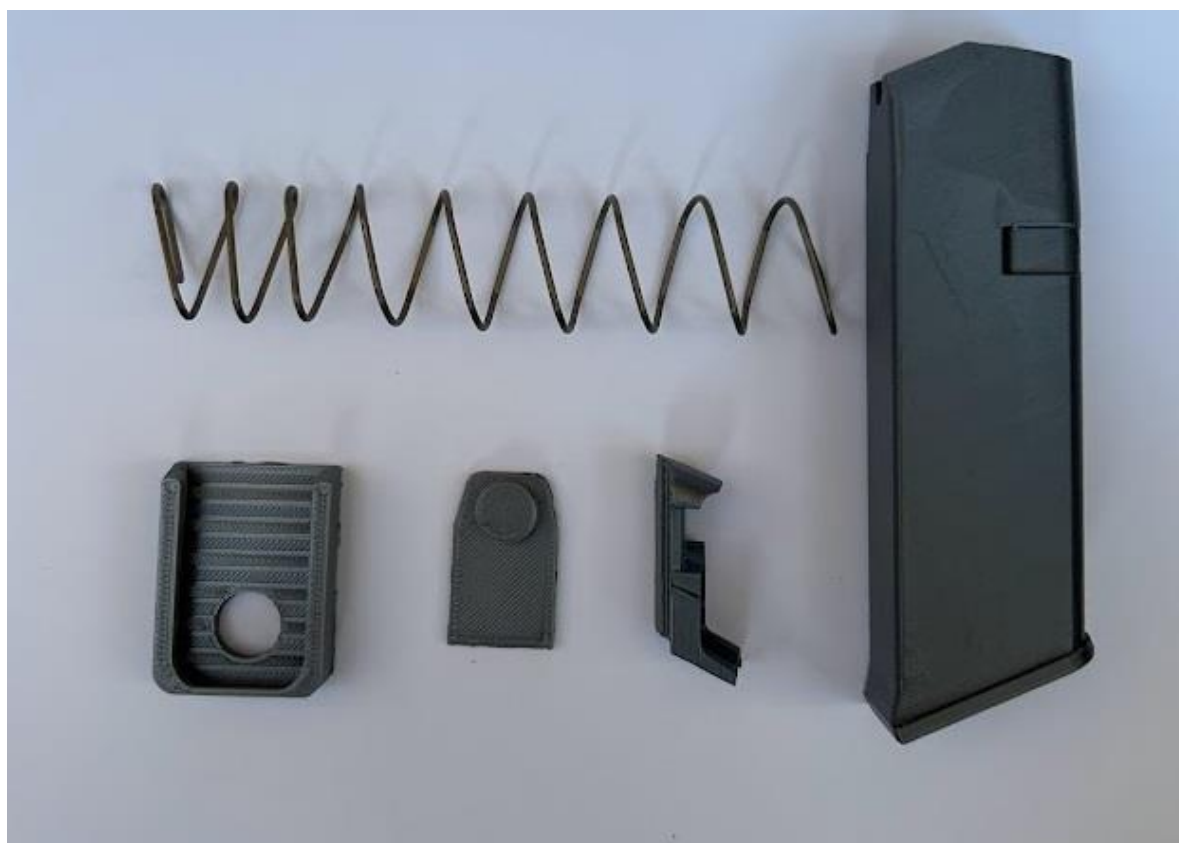
Obrázek 16 – 3D tištěný zásobník rozložený
