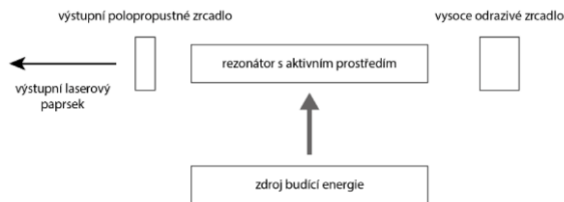
Obrázek č. 5 - Schéma funkce laseru [28]
