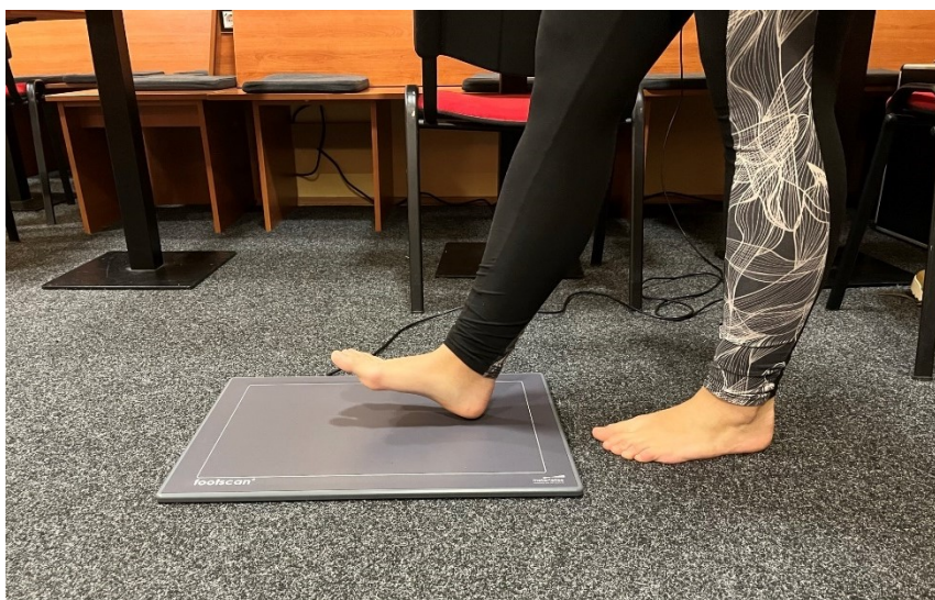
Obrázek 11: Měření pomocí tenzometrické desky, zdroj vlastní
