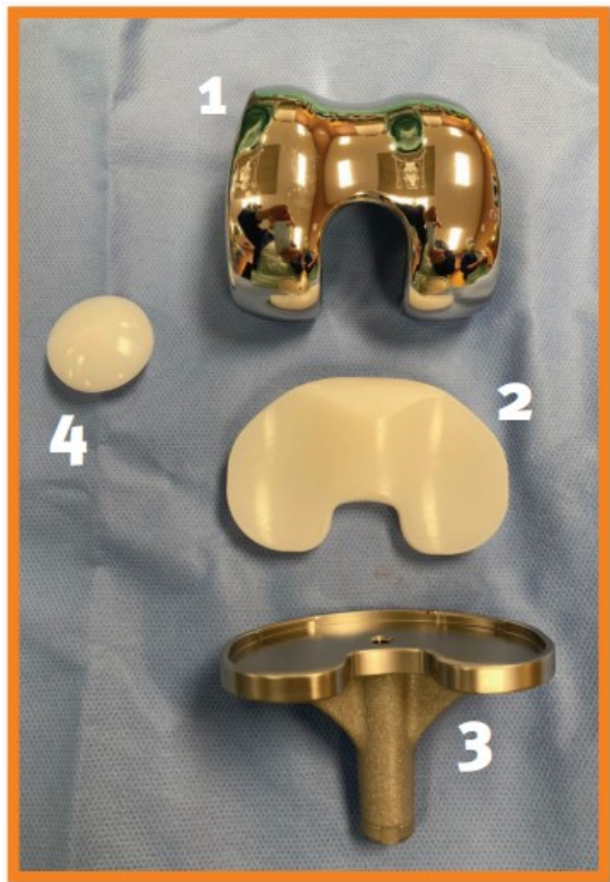
Obrázek 3 - Základní komponenty TEP: 1. Femorální komponenta 2. Polyethylenová vložka 3. Tibiální komponenta 4. Patelární komponenta
