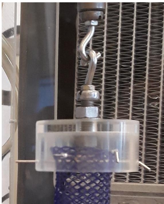
Obrázek 13. Detail speciálních na míru vyrobených držičů stentu
