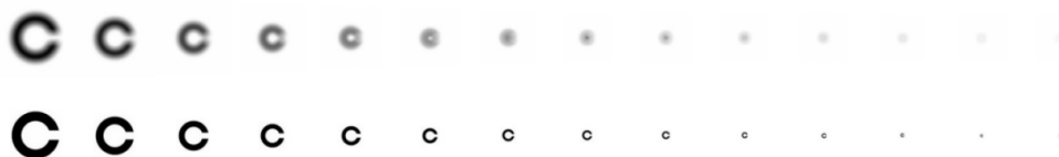
Obrázek 7 - Kompletní sady LO pro RMS 0 \mu\text{m} (dole) a pro RMS 0,9 \mu\text{m} (nahore)
