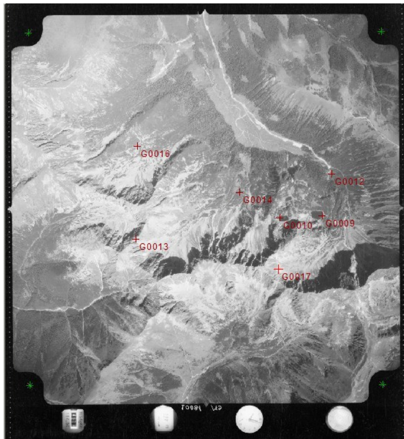
Obrázek 11: Příklad rozmístění vlíčovacích bodů na leteckém snímku
