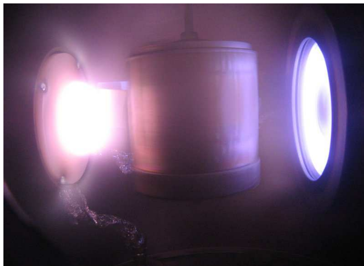
Obr. 4.1: Fotografia depozičnej aparatúry za chodu. Naľavo RF magnetrón s PP terčom a napravo DC magnetrón s Al terčom. Žiariace oblasti označujú erózne dráhy.
